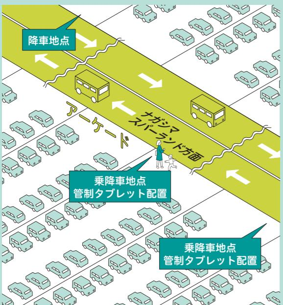
オンドマンド運行管制システムとは、運行状況や設備稼働状況をシステムが監視し、申し込みから目的地の設定までを端末上で行うことのできるシステムのこと。運行管制システムと自動運転車両をつなぎ、将来的な交通インフラとしての運行を見据えています。ナガシマスパーランド駐車場内という限定されたエリアで、自動運転実証実験を行います。
