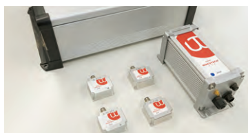
建機に取り付ける各センサーと処理部
