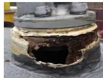
車両上部(アンテナ腐食)
