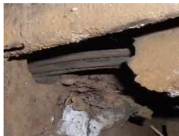
車両下部(電線管腐食)
