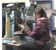
コンロの穴開け作業
