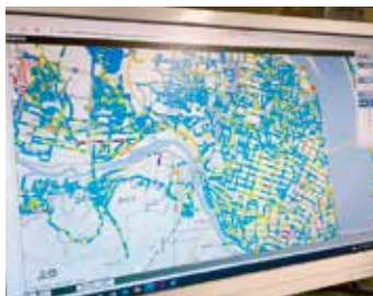
ICTを活用し、道路面の劣化度を色別で示すことができます。
