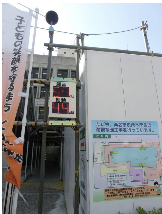
写真1：敷地境界線上の振動・騒音の測定と掲示を実施している。
