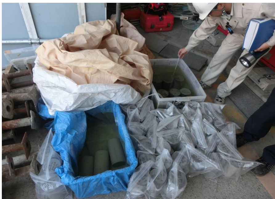
写真2：コンクリート供試体の現場水中養生用水槽
