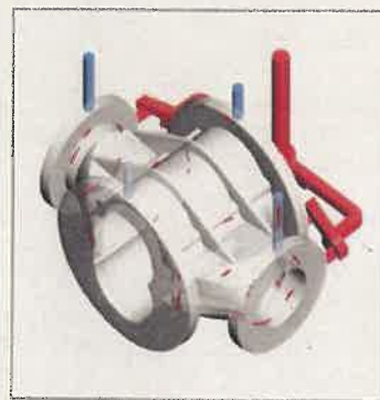
鋳型の設計図 (注ぎ口 含む)
