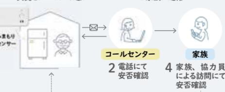
自宅の冷蔵庫にセンサーを設置し、冷蔵庫の開閉の状況をもとに見守りを行います。一定期間、冷蔵庫の開閉がないなどの異常が発生したときはコールセンターによる安否確認を行います。
