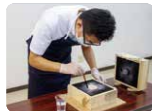
型崩れを防止するために、型の周りに水を筆で塗ります。
